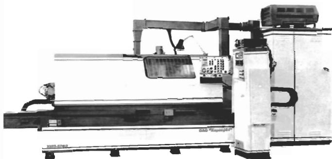
Станки данной модельной группы предназначены для последовательного врезного шлифования профиля кулачков распределительных валов по полуавтоматическому циклу в условиях единичного, серийного и массового производства.
