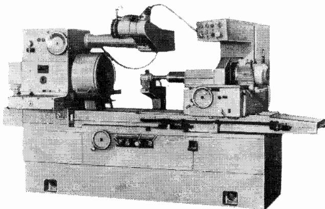
Станок предназначен для шлифования цилиндрических и конических (с углом при вершине до 60°) сквозных и глухих отверстий, шлифования торцов деталей с коническими и цилиндрическими отверстиями с одного установка изделия с помощью торцешлифовального приспособления, установленного на станке.
