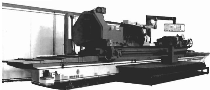
Станки предназначены для наружного шлифования цилиндрических и конических поверхностей деталей максимальной длиной до 8000 мм, весом до 10000 кг. На станках можно производить врезное шлифование и продольное шлифование с автоматической периодической подачей при реверсах стола. Станки изготавливаются в трех исполнениях.
