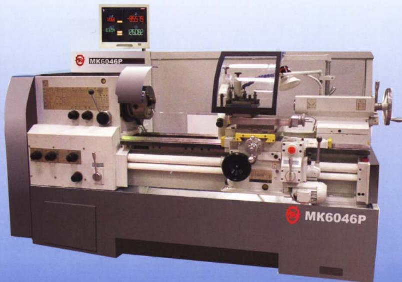
Станки предназначены для выполнения широкого спектра токарных работ: операций наружного точения и растачивания внутренних цилиндрических и конических поверхностей, сверления, зенкерования и развертывания, а также нарезания наружных и внутренних метрических, дюймовых, модульных и питчевых резьб.
