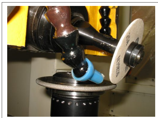
Правка шлифовального круга алмазным роликом
